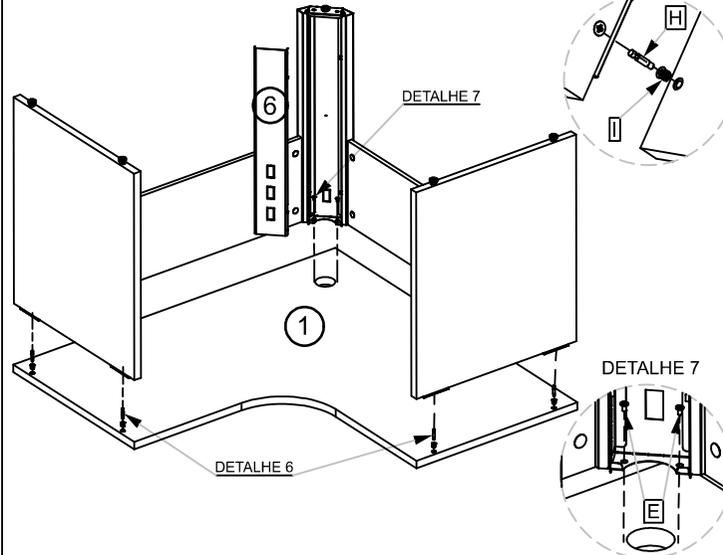
NA SEQUENCIA PARA FACILITAR A FIXAÇÃO O TAMPO (1) NA ESTRUTURA, POSICIONE O TAMPO (1) NO CHÃO E FAÇA A FIXAÇÃO TOTAL DOS PÉS LATERAIS COFORME DETALHE 6, EM SEGUIDA DESTAQUE O FRONTAL DO PÉ CARAMBOLA (6) PARA FIXAR OS PARAFUSOS(E) AO TAMPO (1) COMO INDICAM AS IMAGENS.
